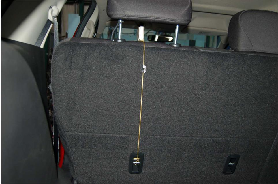
FIGURE 5.18 ROW 2, LEFT SIDE TOP TETHER ROUTING
