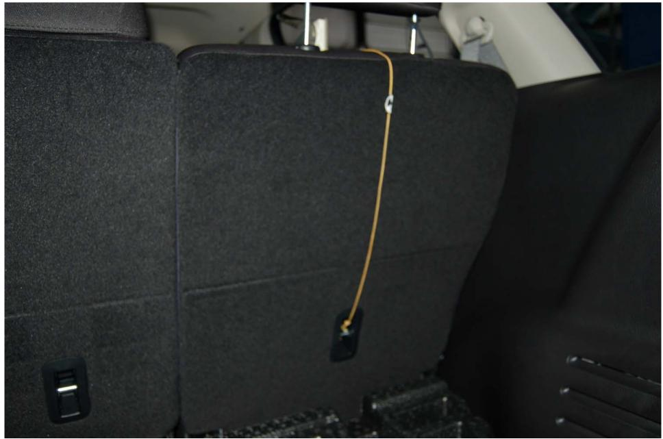
FIGURE 5.22 ROW 2, RIGHT SIDE TOP TETHER ROUTING
