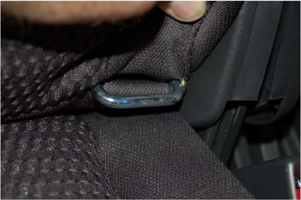
FIGURE 5.11 ROW 2, RIGHT SIDE, INBOARD LOWER ANCHOR, PRE-TEST
