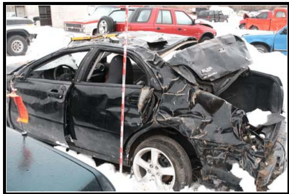
Figure 4. Left side damage, Subaru Impreza
