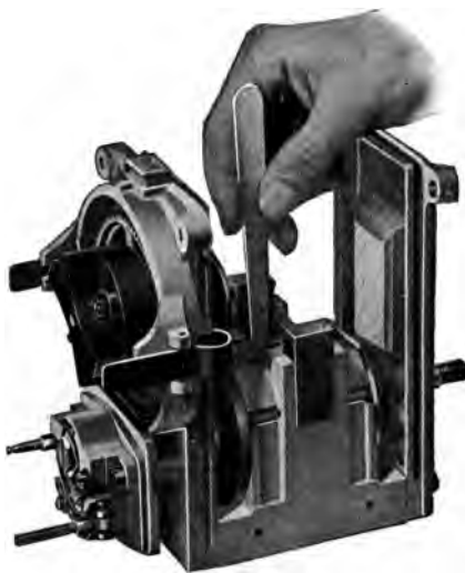
FIG. 306.—Setting rotor edge distance on Aero magneto.
