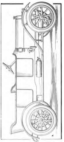
TYPICAL AMERICAN FOUR-CYLINDER TORPEDO TYPE OF AUTOMOBILE
