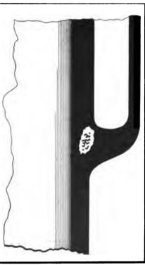
Fig. 85—8PONGE SPOT DUE TO UN-EQUAL COOLING AT THE PART WHERE THE METAL IS BUNCHED
