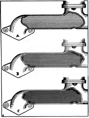
Fig. 81—IGNITION TROUBLE MAY BE DUE TO (A) LEAN MIXTURE, ESPECIALLY IF THE MANIFOLD IS TOO LARGE,
