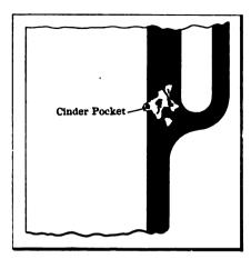
Fig. 90—CINDER POCKET DISCOVERED WHILE REBORING THE CYLINDER TO FIT NEW PISTONS.
