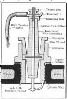
Fig. 75—SECTION OF A SPARK PLUG, SHOWING ONE OF SEVERAL WAYS FOR UTILIZING MICA INSULA-TION SO THAT IT WILL STAND UNDER COMPRESSION
