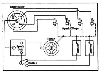
Fig. 44—HIGH-TENSION IGNITION SYSTEM, SHOWING HOW THE DISTRIBUTOR, AND BATTERY ARE CONNECTED UP
